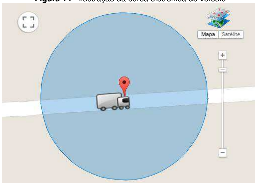
Figura 14 - Ilustração da cerca eletrônica do veículo
