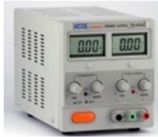
Figura 08 – Fonte de tensão utilizada para alimentação do sistema.
