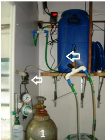
Figura 4: Acréscimo de \text{CO}_2 em um dos meios circulantes de água do mar, mostrando o cilindro do gás (1) e a válvula solenoide que controlou o fluxo de \text{CO}_2 que era injetado por uma mangueira dentro do recipiente (setas).
