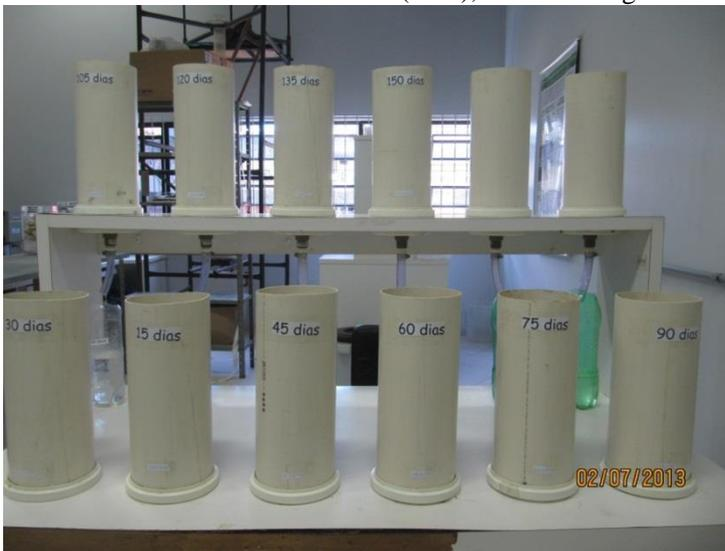
Figura 6: Colunas de areia de fluxo vertical em escala experimental
