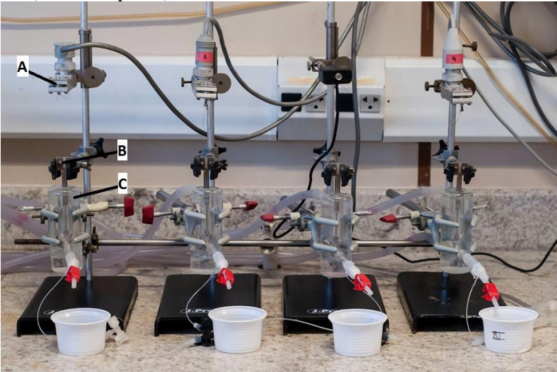
Figura 9 - Sistema para órgão isolado. Em A visualiza-se o transdutor; em B o suporte para fixação do órgão, nesse caso o CC; em C a cuba, nesse caso com capacidade de 6 mL. Fonte: gentilmente cedida por Denise Curi da Cunha, 2014.
