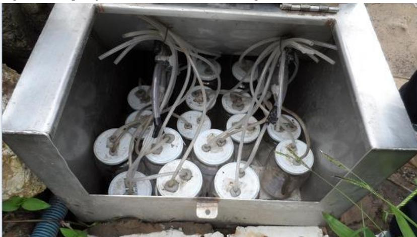
Como se trata de uma galeria de drenagem já existente, foi necessário fazer uma prolongação do tubo de concreto. Como seria necessário fazer orifícios para a coleta de água teve que se escolher um material que fosse maleável, que não sofresse o processo de oxidação e que não afetasse a qualidade das amostras. Por fim chegou-se a conclusão de fazê-lo com aço inox, um material acessível e que se enquadrava nas especificações.
