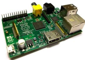
Figura 21 – Raspberry Pi modelo B
