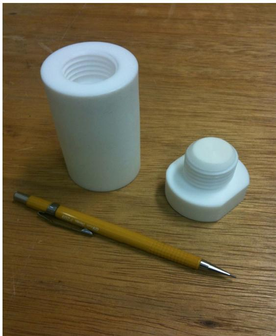
Figura 3.15: Autoclave de PTFE utilizada para síntese hidrotérmica ativada por micro-ondas.
