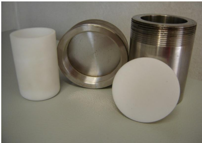
Figura 3.2: Autoclave de aço e o revestimento interno de PTFE com volume de 40 ml.
