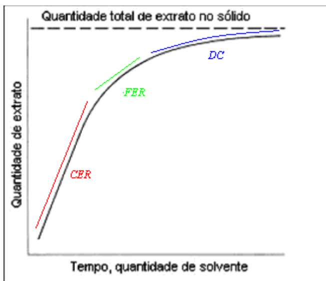
Figura 3: Curva típica de extração com fluido em estado supercrítico.
