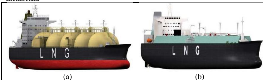
Figura 1.6 - Principais tipos de navios gaseiros: (a) tanque esfera e (b) tanque membrana
