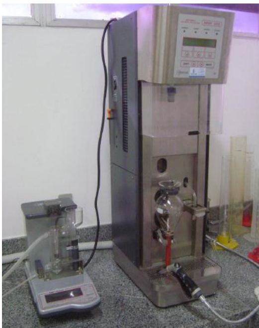
Figura 6: Balança hidrostática digital Alcomat e Destilador Super D.E.E. (Embrapa Semiárido).
