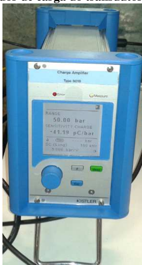
Figura 3-11 - Amplificador de carga do transdutor de pressão piezoelétrico
