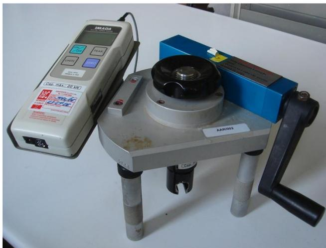
**Figura 14** - Dinamômetro portátil para o ensaio de tração
