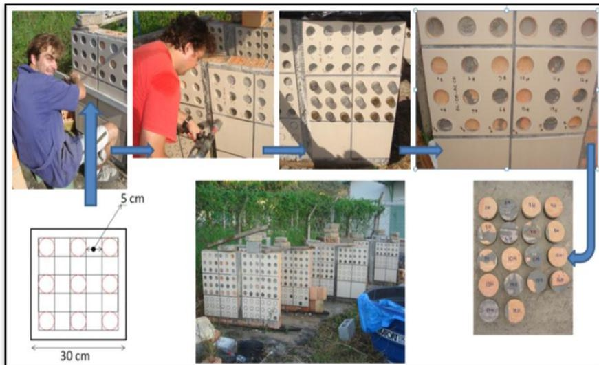
**Figura 12** – Execução do ensaio de arrancamento por tração
