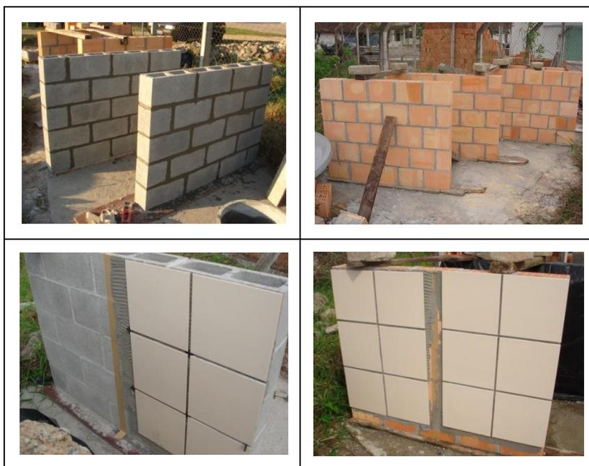
**Figura 23** – Disposição dos painéis no local de ensaio
