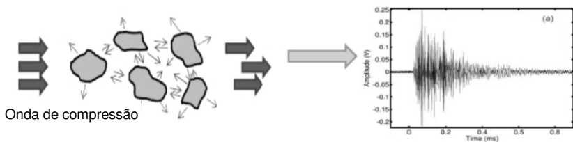
Figura 3.10: Formato da onda de ultrassom após passagem pelo concreto, apresentando dispersão
