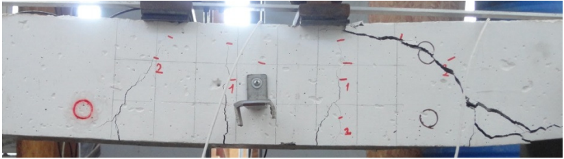
Figura A.2: Manifestação de fissuras ao longo do carregamento na viga 3 - a) Leitura 1 e 2; b) Leitura 3; c) Leitura 4; d) Leitura 5; e) Leitura 6
