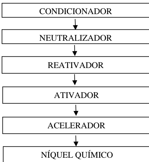
Figura 7 - Fluxograma do Processo Galvânico – pré-tratamento químico.
