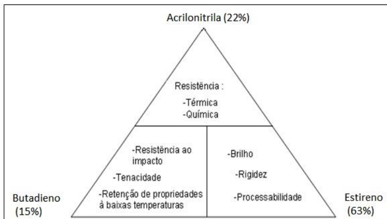
Figura 2 - Triângulo de propriedades dos três monômeros do ABS.
