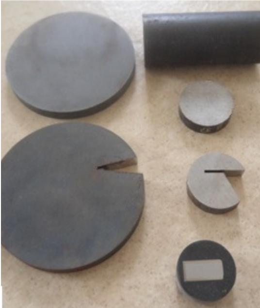
**Figura 37:** Amostras cortadas e embutidas para análise metalográfica.
