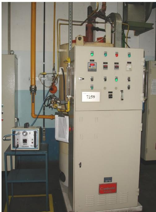
**Figura 10:** Gerador de gás endotérmico.
