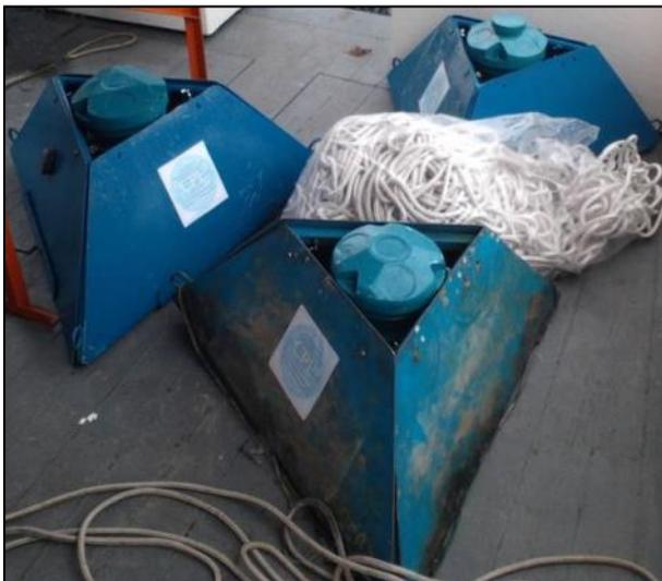
Figura 15 - Perfiladores de correntes (AWAC®) utilizados na aquisição dos dados.
