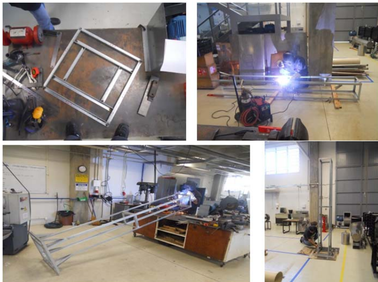
Figura 48 – Construção dos espigões para os trechos de mangueira com rosca de 2" BSPT
