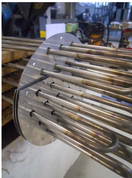
Figura 66 – Sequencia de montagem da terceira chicana (D)
