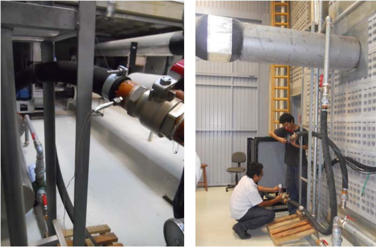
Figura 77 – Adequação e instalação de hastes para incorporar os termopares encarregados da leitura da temperatura no ar (A)
