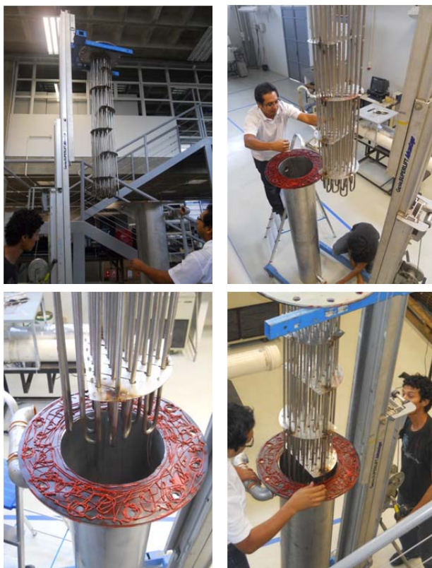
Figura 70 – União do conjunto de resistências e flange ao casco do aquecedor
