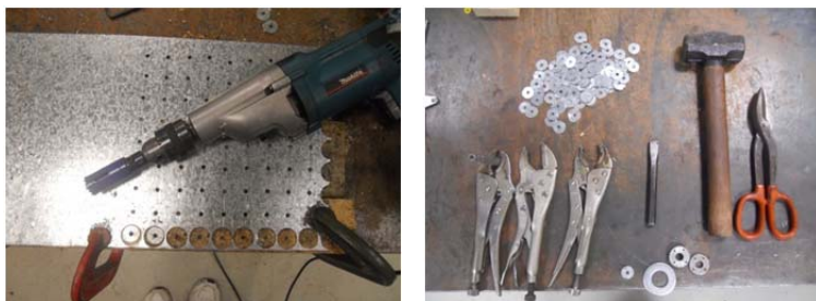
Figura 15 – Processo de fabricação de rebites (A)
