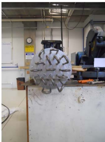
Figura 62 – Montagem da segunda chicana (B)
