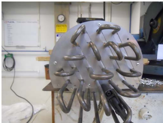
Figura 62 – Montagem da segunda chicana (B)
