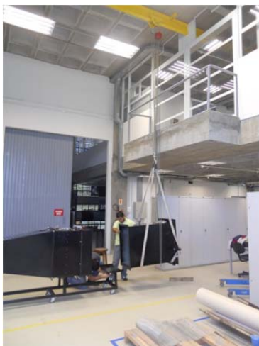
Figura 39 – Radiador e seção final montadas sobre a base móvel.
