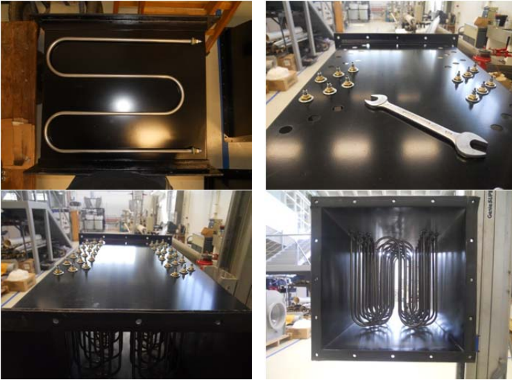
Figura 27 – Detalhe da base mostrando as barras rosqueadas para a regulagem da altura de cada secção
