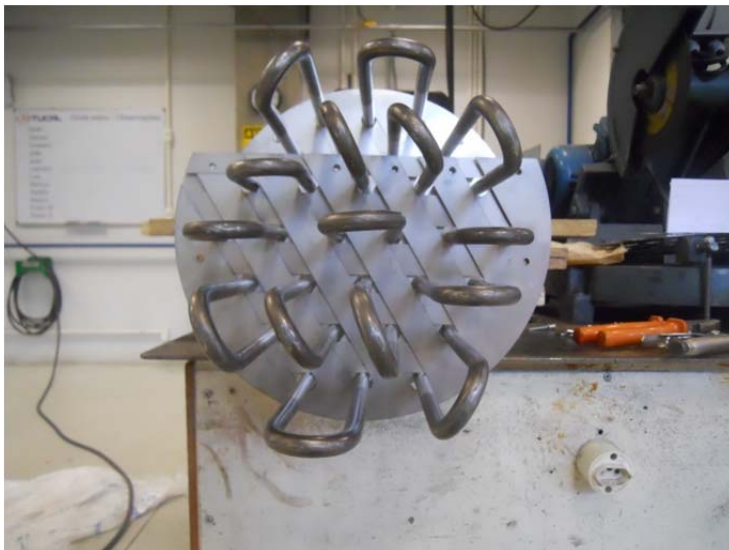
Figura 66 – Sequencia de montagem da terceira chicana (D)
