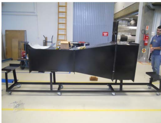
Figura 28 – Montagem parcial do túnel
