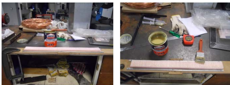
Figura 5 – União dos jogos de canudos até atingir 540 mm de comprimento
