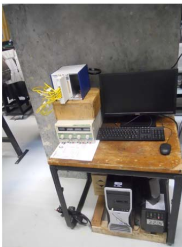
Figura 79 – Computador, fonte de potencia e sistema de aquisição de dados para obter a captação das leituras dos instrumentos de medição.
