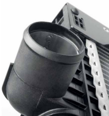
(a) Detalhe do reservatório do radiador
