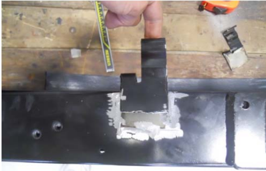
Figura 7 – Tirando do radiador os sujeitadores do CAC
