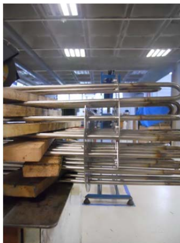
Figura 62 – Montagem da segunda chicana (B)
