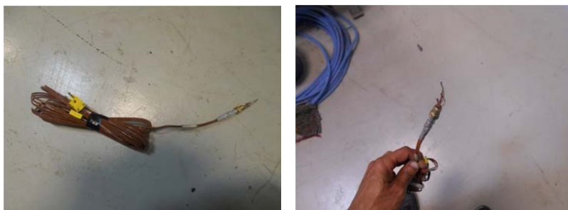
Figura 75 – Termopares instalados em espigões de 1/4" para aquisição da temperatura na água
