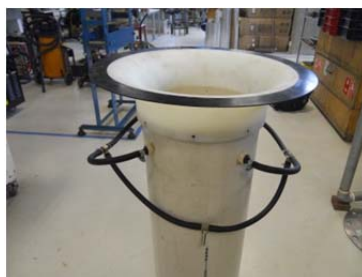
Figura 44 – Anel de pressão instalado no duto de sucção (A)
