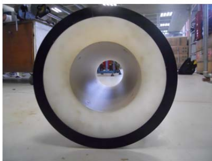
Figura 41 – Duto de sucção com o bocal e o acople instalados nas suas duas extremidades
