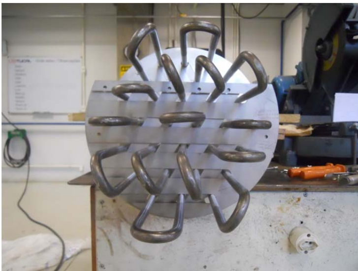
Figura 64 – Sequencia de montagem da terceira chicana (B)
