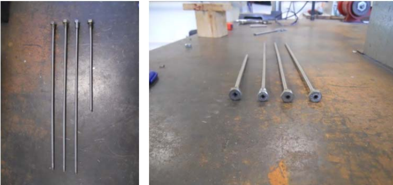
Figura 77 – Adequação e instalação de hastes para incorporar os termopares encarregados da leitura da temperatura no ar (A)
