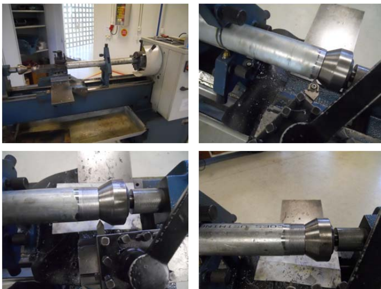
Figura 50 – Elaboração do cone de 1,5° e começo de rosca BSPT de 2” no torno do laboratório
