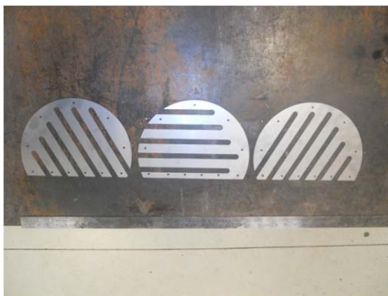
Figura 58 – Corte a laser das 3 chapas que formam uma chicana do aquecedor
