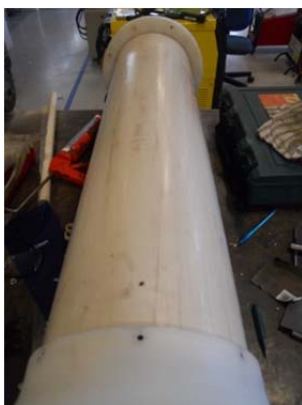
Figura 41 – Duto de sucção com o bocal e o acople instalados nas suas duas extremidades
