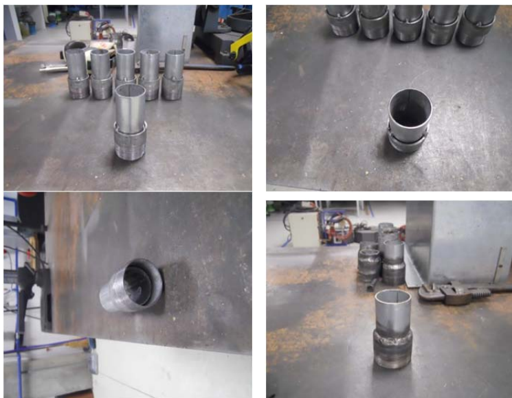
Figura 48 – Construção dos espigões para os trechos de mangueira com rosca de 2" BSPT
