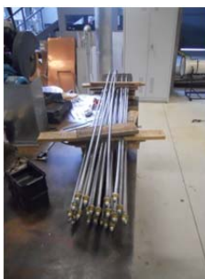
Figura 60 – Montagem da primeira chicana nos feixes de resistências
