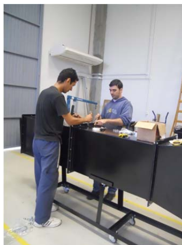
Figura 29 – Instalação da tela na metade das seções do aquecedor
