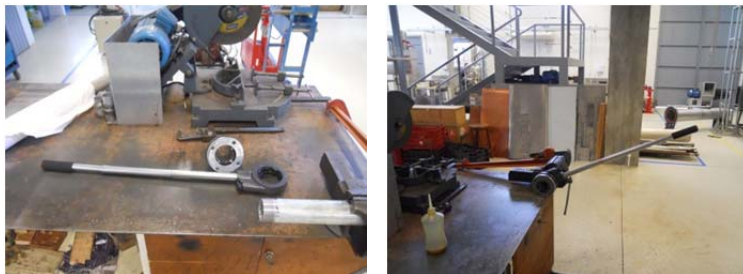
Figura 52 – Terminação da rosca através da tarraxa manual (B)
