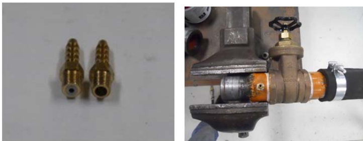
Figura 49 – Adequação de espigões de ¼” como tomadas de pressão e instalação dos mesmos
