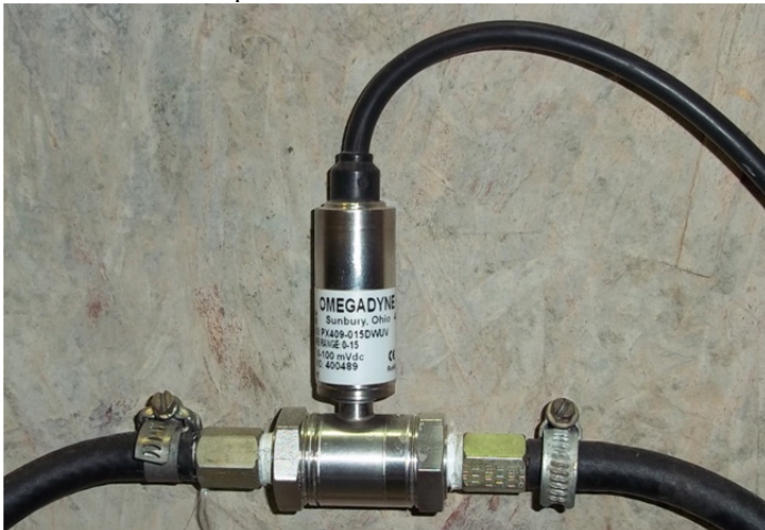
Figura 64 – Transdutor de pressão diferencial do sistema hidráulico
