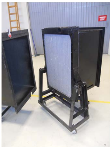
Figura 39 – Radiador e seção final montadas sobre a base móvel.
