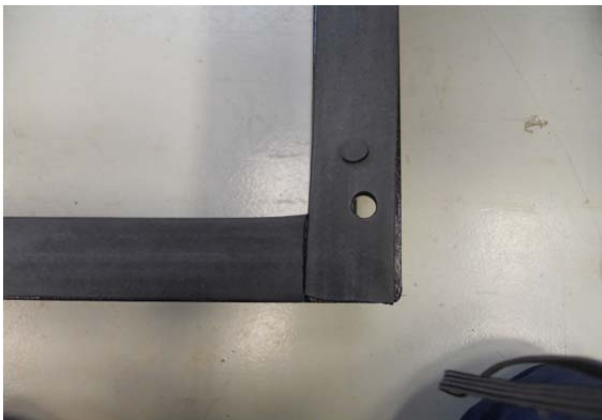
Figura 25 – Sequencia de furação de uma cantoneira (C)
