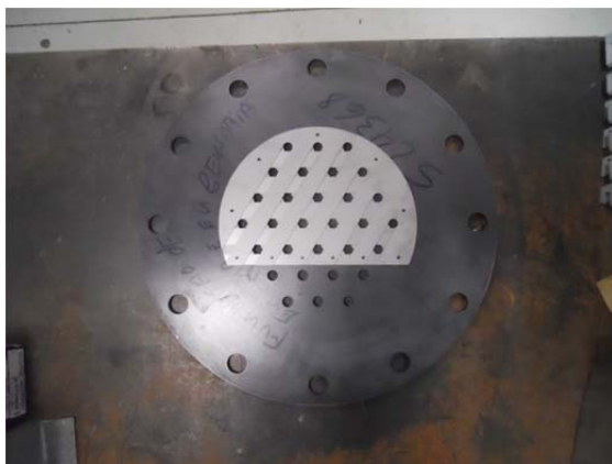
Figura 59 – Ensamble de uma chicana sobre o flange do aquecedor
