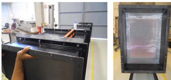
Figura 36 – Instalação da segunda malha na câmara de retificação
