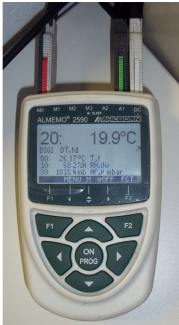
Figura 61 – Sistema de aquisição de dados marca AHLBORN modelo ALMEMO 2590-4S
