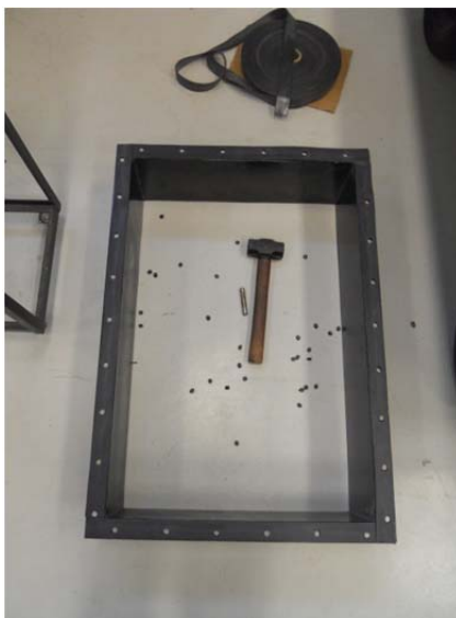
Figura 25 – Sequencia de furação de uma cantoneira (C)
