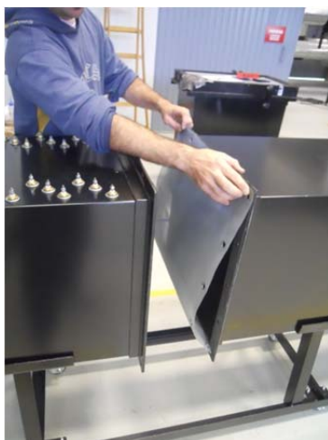
Figura 29 – Instalação da tela na metade das seções do aquecedor
