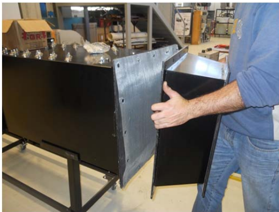
Figura 31 – Vista parcial do ensamble do túnel de vento
