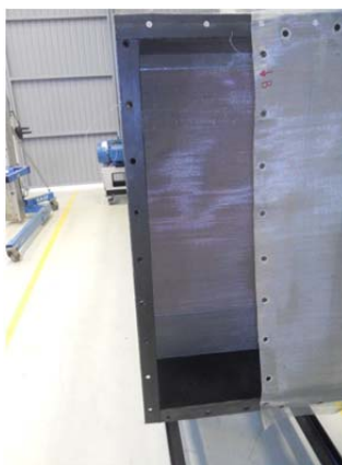
Figura 37 – Seção de teste e radiador acoplados
