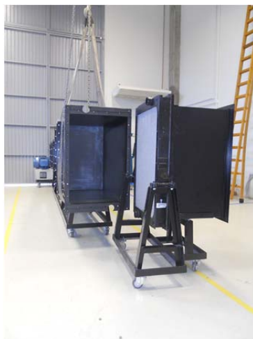
Figura 39 – Radiador e seção final montadas sobre a base móvel.
