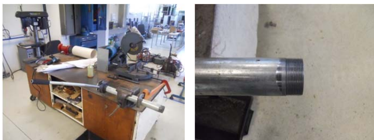
Figura 52 – Terminação da rosca através da tarraxa manual (B)
