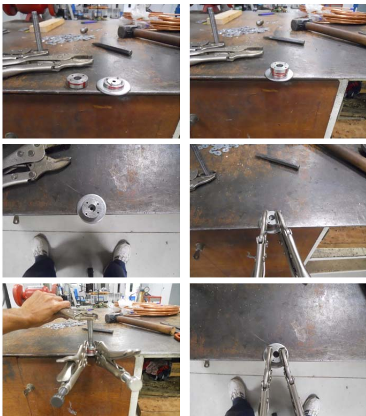
Figura 15 – Processo de fabricação de rebites (A)
