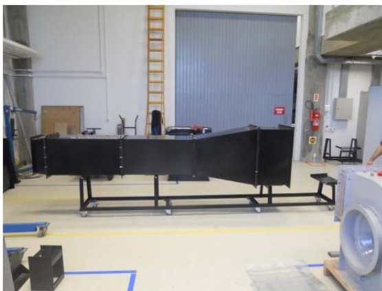
Figura 31 – Vista parcial do ensamble do túnel de vento
