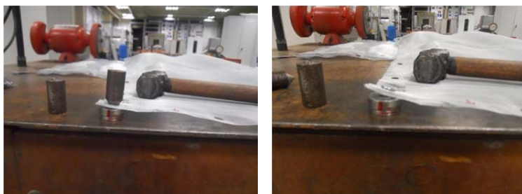
Figura 18 – Sequencia de aplicação de um rebite na tela (A)
