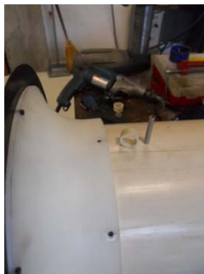
Figura 44 – Anel de pressão instalado no duto de sucção (A)
