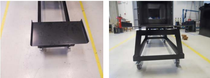
Figura 27 – Detalhe da base mostrando as barras rosqueadas para a regulagem da altura de cada secção
