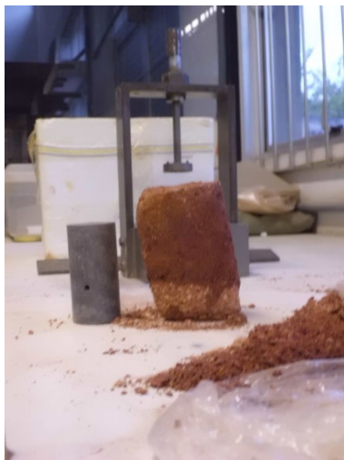
Figura 140 – Estrutura reliquiar observada durante processo de moldagem do CP
