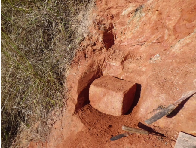
Figura 52 – Coleta de amostra no Talude
