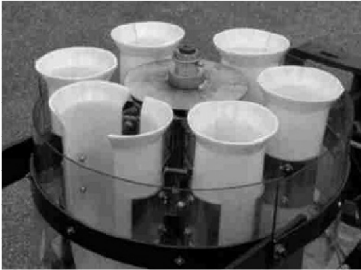
Figura 3.7: a) Dosador do transplanto de mudas; b) Transplantadora de mudas Holandesa
