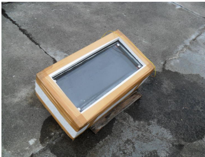
Figura 73 - Protótipo vedado com chapas de poliestireno expandido, apresentando vazamentos de água.
