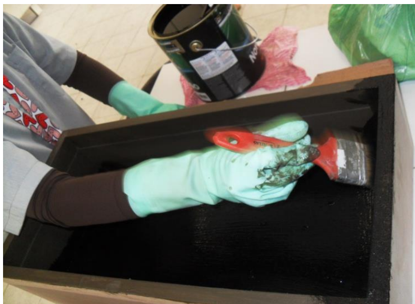
Figura 60 - Caixa do protótipo já impermeabilizada, recebendo pintura preta na parte interna.
