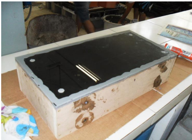
Figura 61 - Caixa finalizada, com fechamento superior em vidro fixo por silicone.
