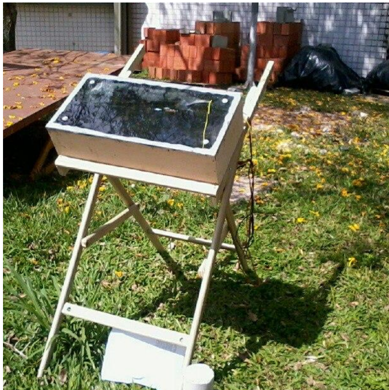
Figura 62 - Caixa do protótipo sobre cavalete com inclinação 27°, exposto no estacionamento do prédio da Engenharia Civil da UFSC.
