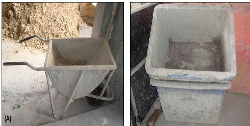
Figura 53. (A) Carrinho com um volume estimado de  $0,086\text{m}^3$ – (B) Caixa volume de  $0,20\text{m}^3$ .
