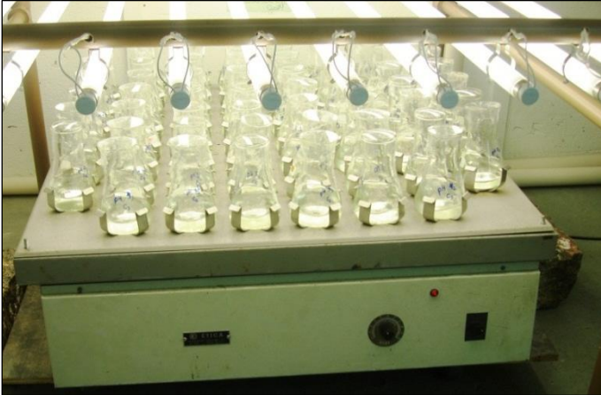
Figura 9. Agitador orbital para o cultivo de Chlamydomonas sp.
