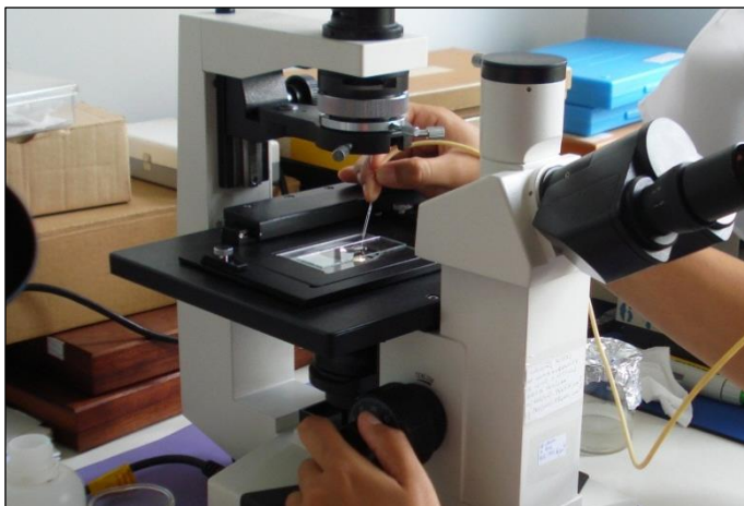
Figura 8. Isolamento de Chlamydomonas sp. através do método de sucção com o auxílio de capilar acoplada a mangueira de silicone.
