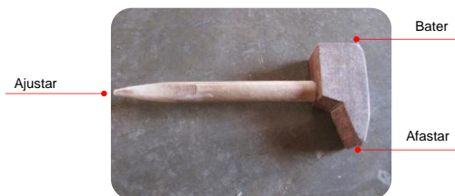
Figura 31 – Martelo de madeira para trançar assentos e suas funções.
