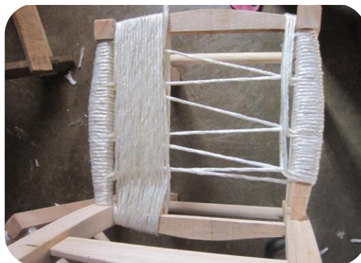
Figura 32 – O trançado normal em execução, à relação entre fios e a disposição das cordas junto ao suporte do assento.
