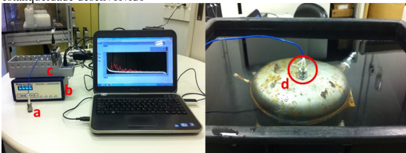
Figura 35 - Bancada de ensaios em laboratório com sistema de avaliação de estanqueidade desenvolvido
