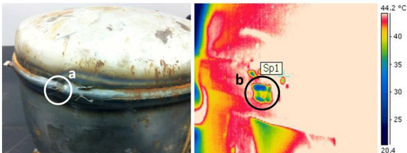
Figura 17 - Imagem real e termograma gerado do compressor hermético no primeiro ciclo de ensaios
