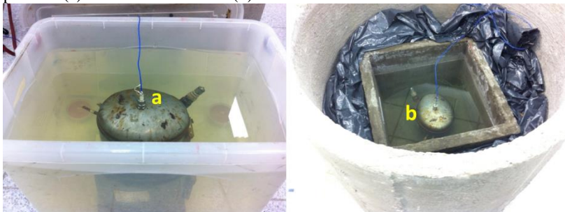
Figura 41 - Acelerômetro acoplado ao compressor submerso no recipiente de plástico (a) e na cabine acústica (b)
