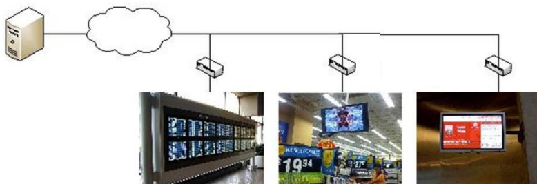
Figura 25: Estrutura de um sistema de Digital Signage .
