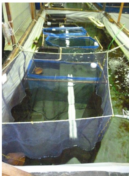
Figura. Tanque retangular de concreto, de 8.000L. O casal de A. clarkii , era mantido no tanque-rede suspenso.
