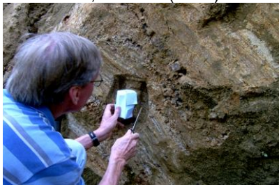
Fig. 83 – Coleta de amostra de solo para laminação. Foto: PARIZOTO, D. G. V. (2011).
