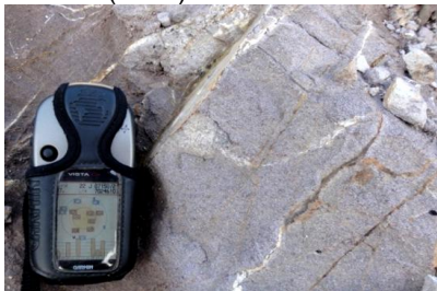
Fig. 81 – Granulítico com plano de fratura N40°E. Foto: PARIZOTO, D. G. V. (2011).
