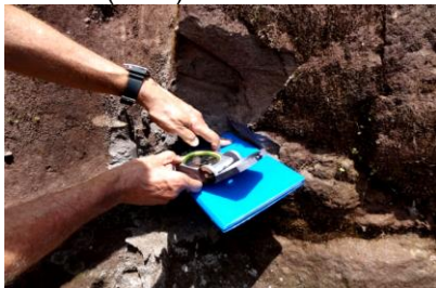
Fig. 80 – Medições de inclinação das camadas. Foto: PARIZOTO, D. G. V. (2011).
