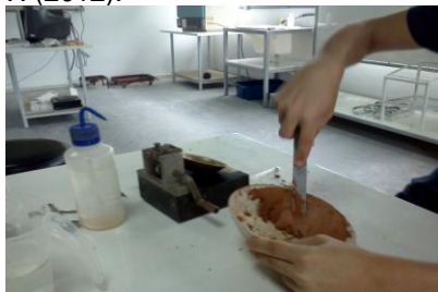
Fig. 103 – Preparação da amostra para o ensaio do Limite de Liquidez. Foto: PARIZOTO, D. G. V. (2012).
