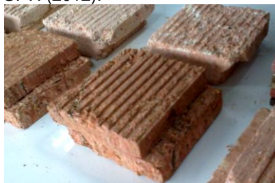
Fig. 102 – Detalhe das amostras cisalhadas. Foto: PARIZOTO, D. G. V. (2012).
