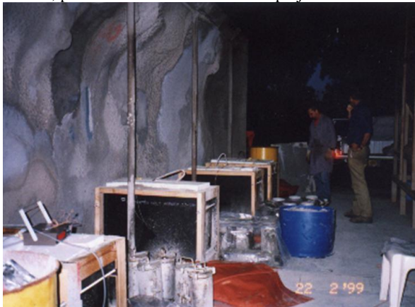
Figura 9 – Blocos, prismas e cilindros de concreto projetado ainda em seus moldes
