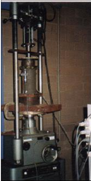
Figura 13 – Montagem do ensaio de Módulo de Elasticidade nas primeiras idades
