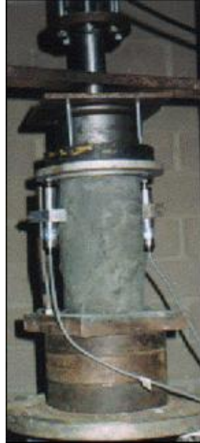
Figura 14 – Detalhe dos LSCTs em ambos os lados do corpo de prova de módulo de elasticidades nas primeiras idades
