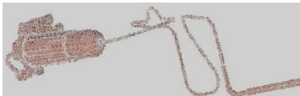
Figura 74 - Malha acústica do filtro acústico de descarga.
