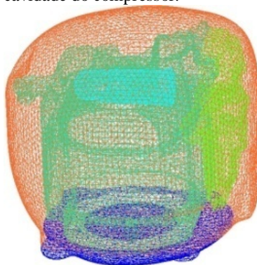
Figura 81 - Malha da cavidade do compressor.
