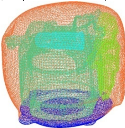
Figura 65 - Representação da malha da cavidade do compressor.
