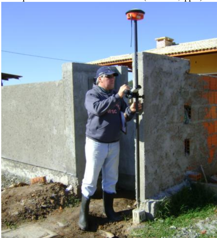
Figura 24: Levantamento dos vértices das parcelas territoriais utilizando o método RTK, em 12-08-2013 (Fonte: o autor).
