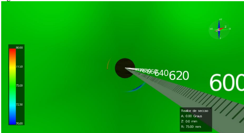
Figura 46 – Duto simulado nas figuras 44 e 45 corrigido pela aplicação do algoritmo 3D desenvolvido.
