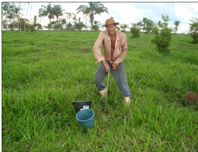
Foto 1. Agricultor C23 utilizando trado holandês na coleta de solo em 02/11/2011. Alta Floresta-MT. Fonte: O autor (2011)
