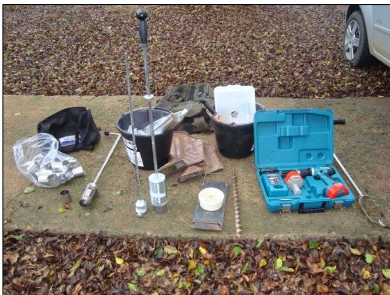
Foto 2. Kit utilizado para amostragem de solos. Alta Floresta-MT. Fonte: O autor (2011).
