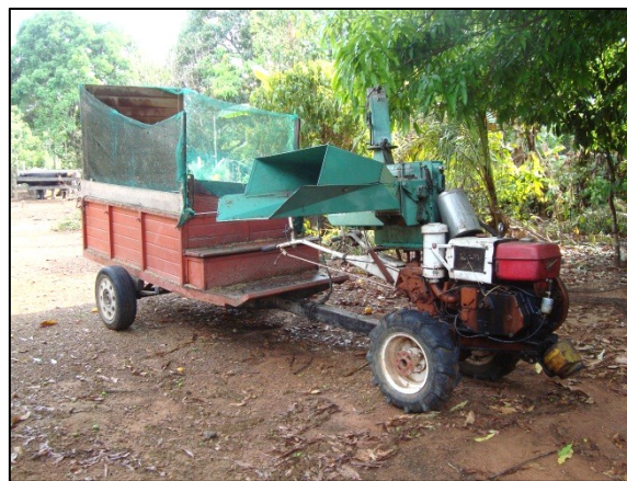
Foto 9. Microtrator do agricultor C55 equipado para corte e transporte de cana,. Alta Floresta-MT. Fonte: O autor (2013).
