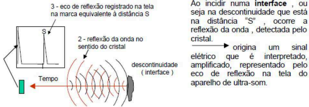
Figura 7 - Esquema de captação do eco do pulso ultra-sônico.
