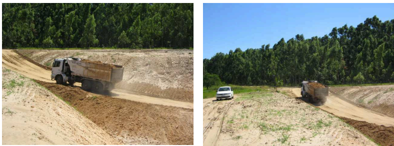
Figura 19 - Caminhão caçamba carregado de areia sem a lona protetora.
