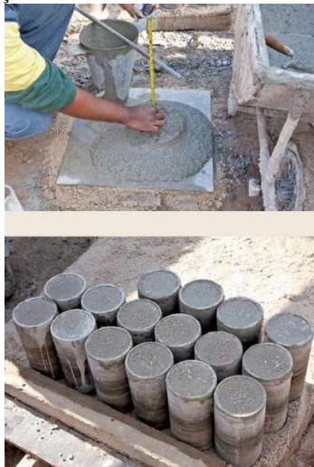
Figura 29 - Realização do ensaio de abatimento ou slump test do concreto
