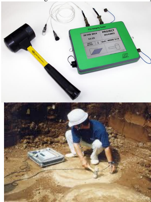
Figura 47 - Ensaio de integridade de estacas de baixa deformação com PIT
