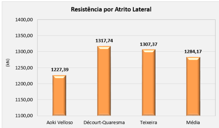
Figura 77 - Resistência por atrito lateral desenvolvida ao longo do fuste da estaca em estudo
