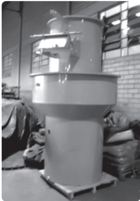
Figura 24. Foto de um filtro lento com retrolavagem e dispositivo de acionamento automático da retrolavagem construído em polipropileno
