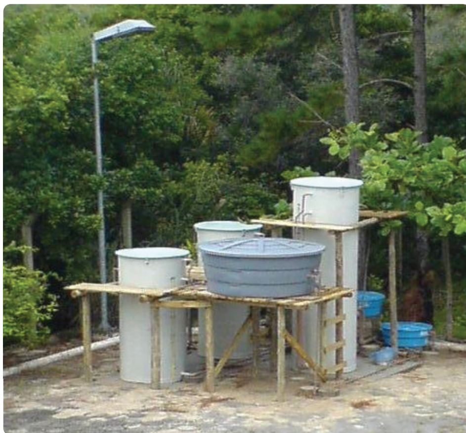
Figura 16. Foto de 3 filtros: Filtro do tipo convencional (o mais baixo), filtro com retrolavagem com água filtrada (da direita) e filtro com retrolavagem com água bruta (do meio). Foto de Pizzolatti, B. S. (2012).
