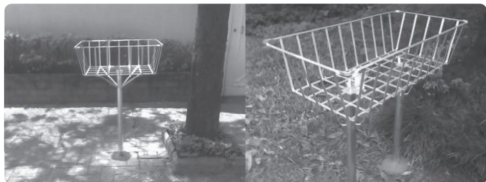
Figura 2 : Cestos galvanizados para acondicionamento dos resíduos sólidos domiciliares.
