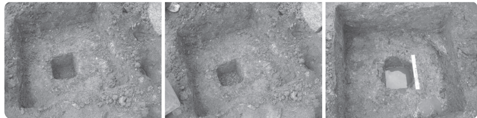
Figura 31: Fotos do ensaio de infiltração (Acervo GESAD/ENS-UFSC).
