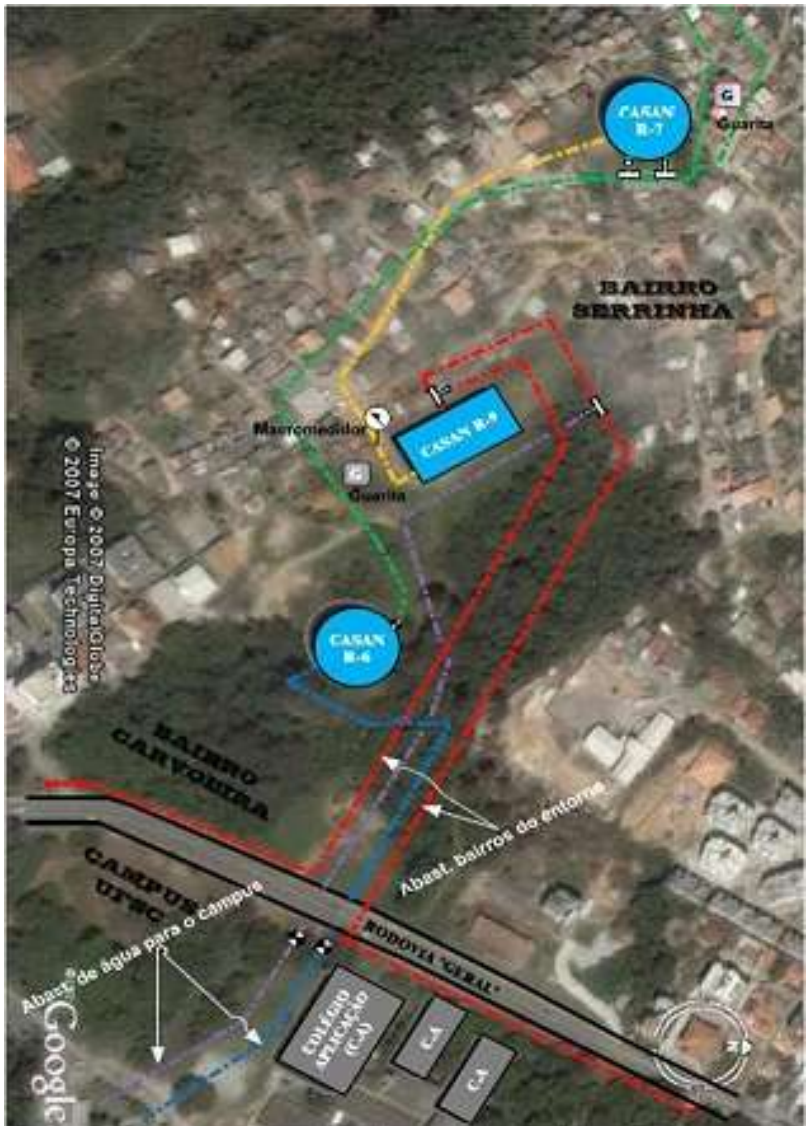
Figura 2: ilustração do sistema de abastecimento e reserva de água do campus
