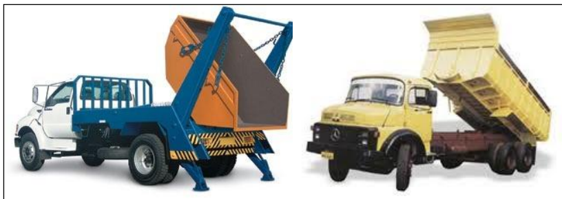
Figura 4: Caminhão poli guindaste com caçamba metálica estacionária, à esquerda, e caminhão caçamba, à direita.
