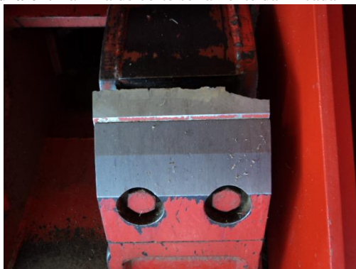
Figura 62: Lâmina de corte seriamente danificada
