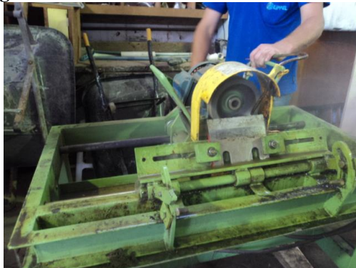
Figura 40: Lâmina sendo afiada na mesa afiadora
