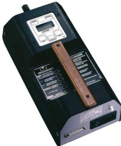
Este equipamento faz uma leitura indireta da concentração de  $H_2S$  a qual ele está submetido através da medição da resistividade elétrica de um fio de ouro, visto que é sabido que o ouro varia sua resistividade elétrica proporcionalmente à concentração de  $H_2S$  à qual ele está submetido.
