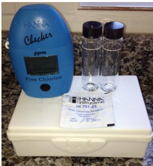
Figura 20 – Colorímetro utilizado para quantificar o cloro residual. Fonte: Elaborado pelo autor.
