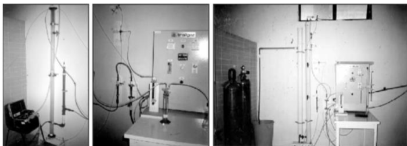
(a) (b) (c) Figura 6 - Unidades de laboratório utilizadas para desinfecção com ozônio: a) reator de coluna, em batelada; b) misturador estático, em contínuo; c) reator de duas colunas, em contínuo. Fonte: Gonçalves (2003).
