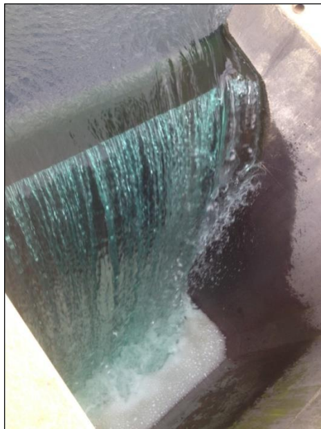
Figura 24 – Foto que ilustra o momento de saída do corante alimentício no TAS. Fonte: Elaborado pelo autor.
