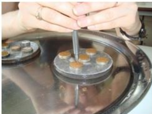
Figura 11 – Medição da penetração no centro das pastilhas
