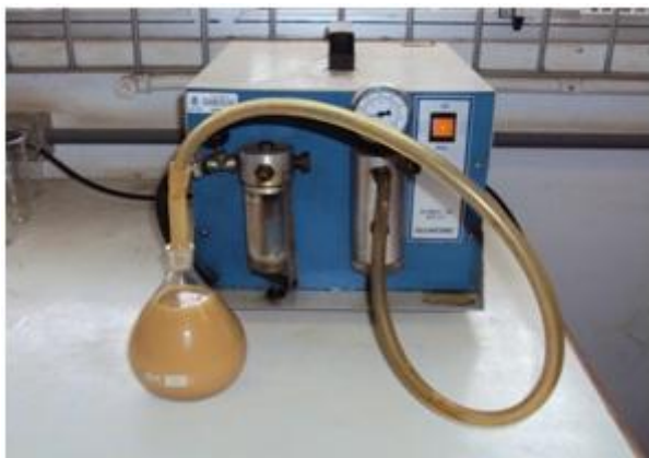
Figura 12 – Eliminação de bolhas de ar com o uso de bomba de sucção
