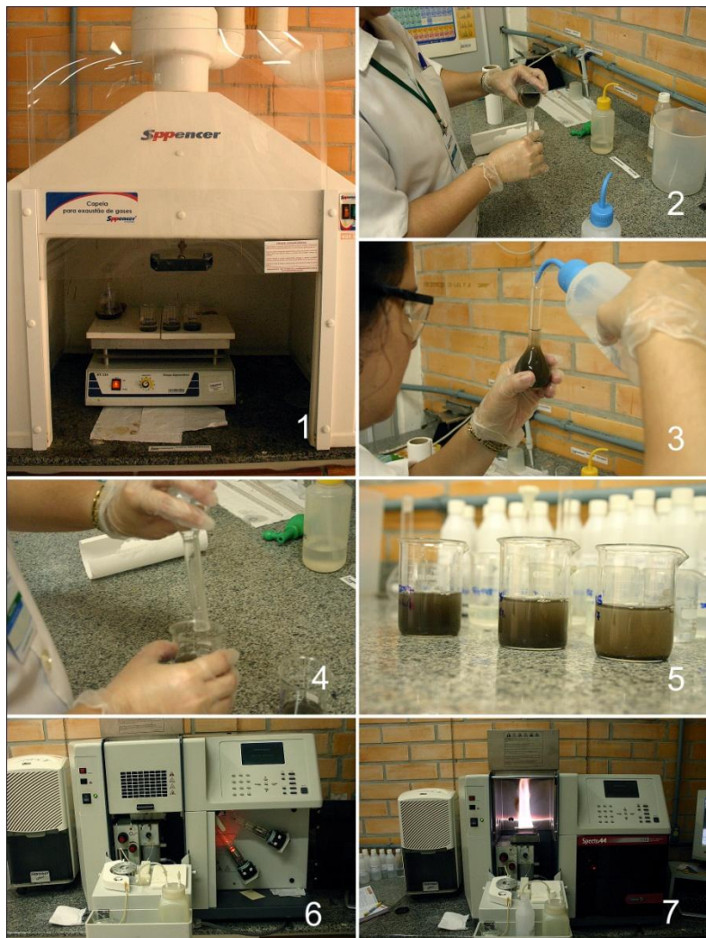
Figura 10. Etapas do ensaio de espectrofotometria de absorção atômica. Legenda: 1 – Abertura das amostras de percolado na capela de exaustão de gases; 2 – Percolado que já passou pela abertura sendo colocado no balão volumétrico; 3 – Balão volumétrico com percolado sendo preenchido com água, até obtenção de 50 mL de amostra líquida; 4 – Colocação dos 50 mL de amostra líquida no copo bécker; 5 – Triplicata das amostras de percolado com o volume de 50 mL para a realização do ensaio; 6 – Lâmpada de leitura dos comprimentos de onda do espectrofotômetro, inserida no equipamento; 7 – Chama do ensaio de espectrofotometria.
