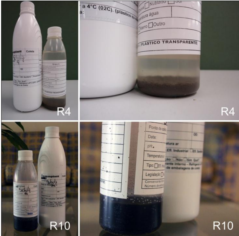
Figura 9. Amostras de percolado coletadas dos corpos de prova das ADFs após a determinação do coeficiente de condutividade hidráulica. Legenda: R4 – Amostra nomeada R4, com o teor de 4% de bentonita na sua composição; R10 – Amostra nomeada R10, com o teor de 6,5% de bentonita na sua composição.
