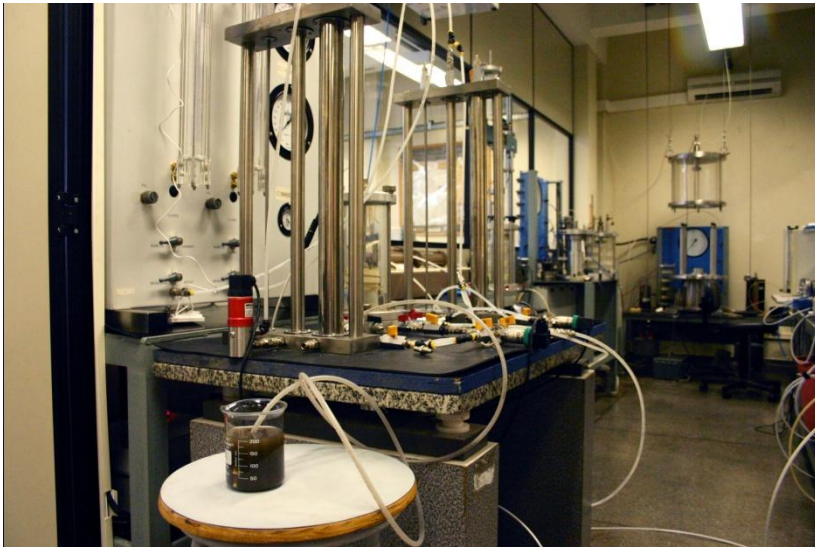
Figura 7. Fase de percolação do ensaio de determinação do coeficiente de condutividade hidráulica.
