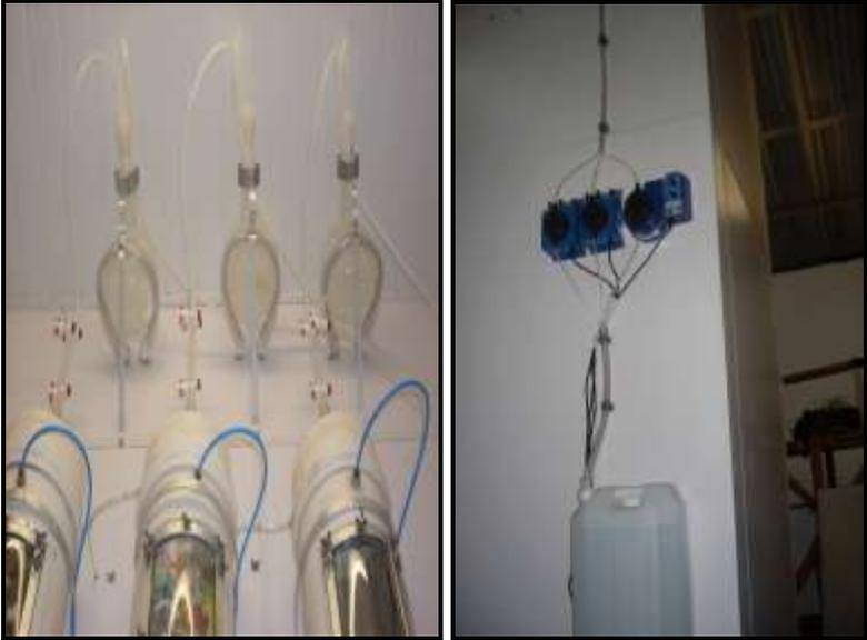
**Figura 6: Sistema de lavagem dos gases e bombas para injeção de água ultrapura.**
