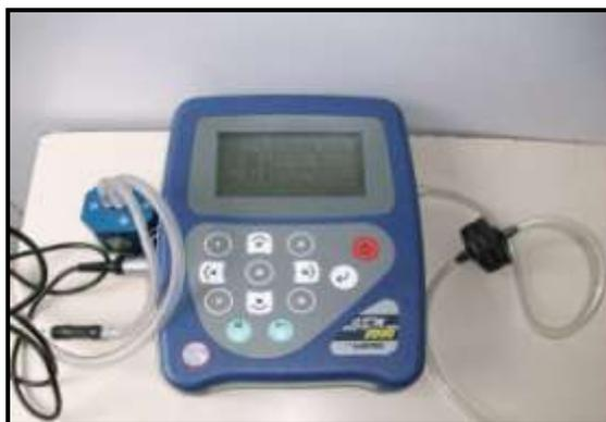
**Figura 7: Medidor de Concentração de Gases.**
