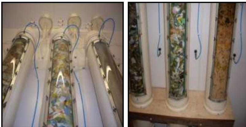
**Figura 8:** Sistema de mangueiras e válvulas para utilização do medidor de concentração de gases.
