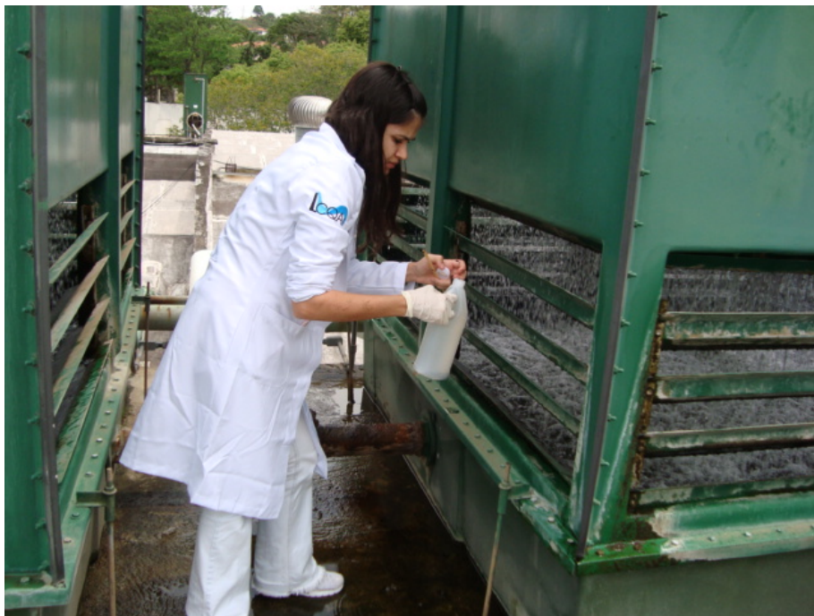
Figura 13: Coleta de amostra na torre de resfriamento do Hospital A.
