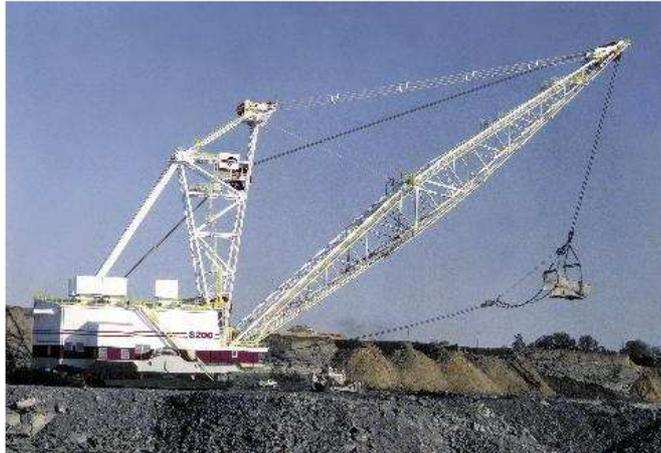
Figura 4-2: *Dragline* utilizada na mineração a céu aberto (Fonte: Empresa Bucyrus)
