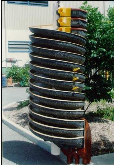
Figura 4-5: Espiral concentrador (Fonte: empresa Rochemt)
