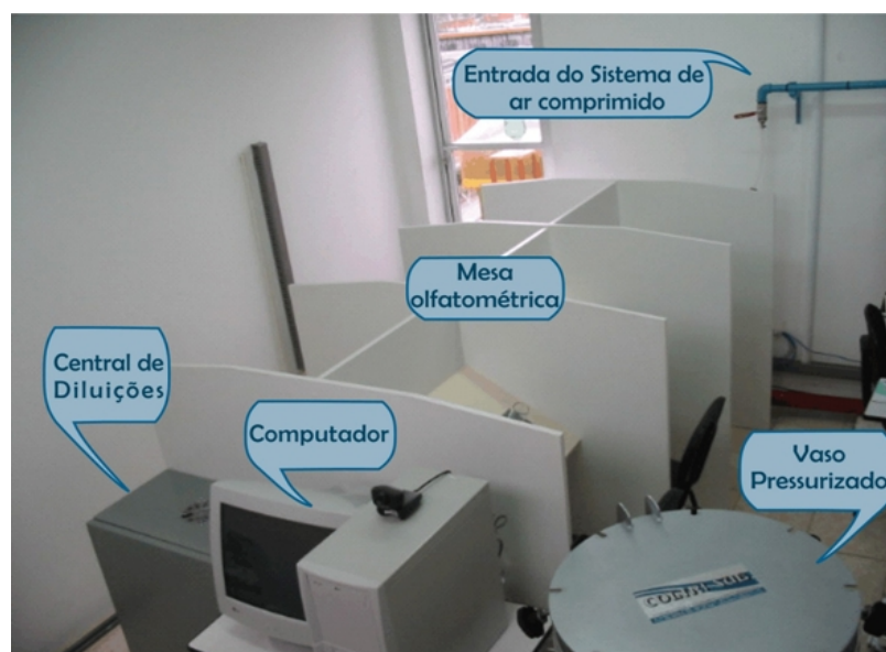
Figura 4.13: Componentes do sistema do olfatômetro ODILE 2000
