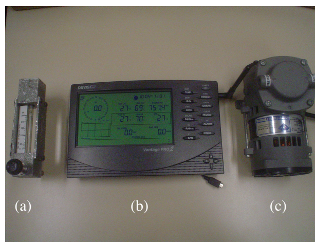
Figura 16 – (a), Rotâmetro; (b) console de uma estação meteorológica; (c) bomba a vácuo/pressão.
