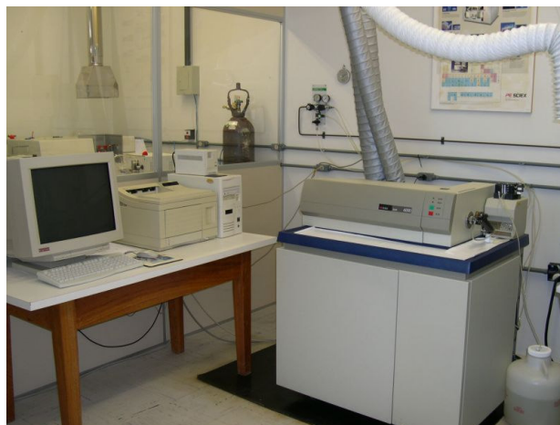
Figura 21 – Foto ilustrativa de um ICP-MS modelo Elan 6000.
