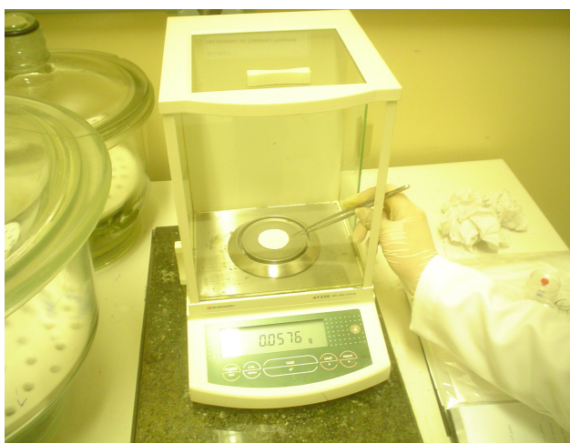
Figura 14 – Pesagem dos filtros em balança analítica.
