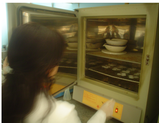
Figura 12 – Filtros sendo colocados em estufa a 100°C no LIMA.
