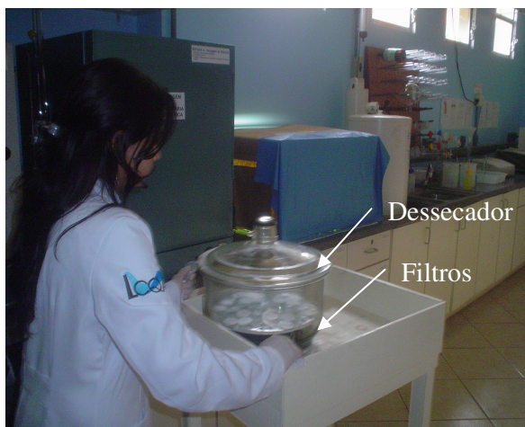
Figura 13 – Filtros acondicionados em dessecador, sendo encaminhados à sala de pesagem.
