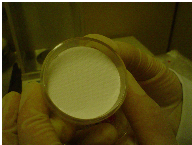
Figura 15 – Filtro inserido no porta-filtro recobrimdo toda a superfície.
