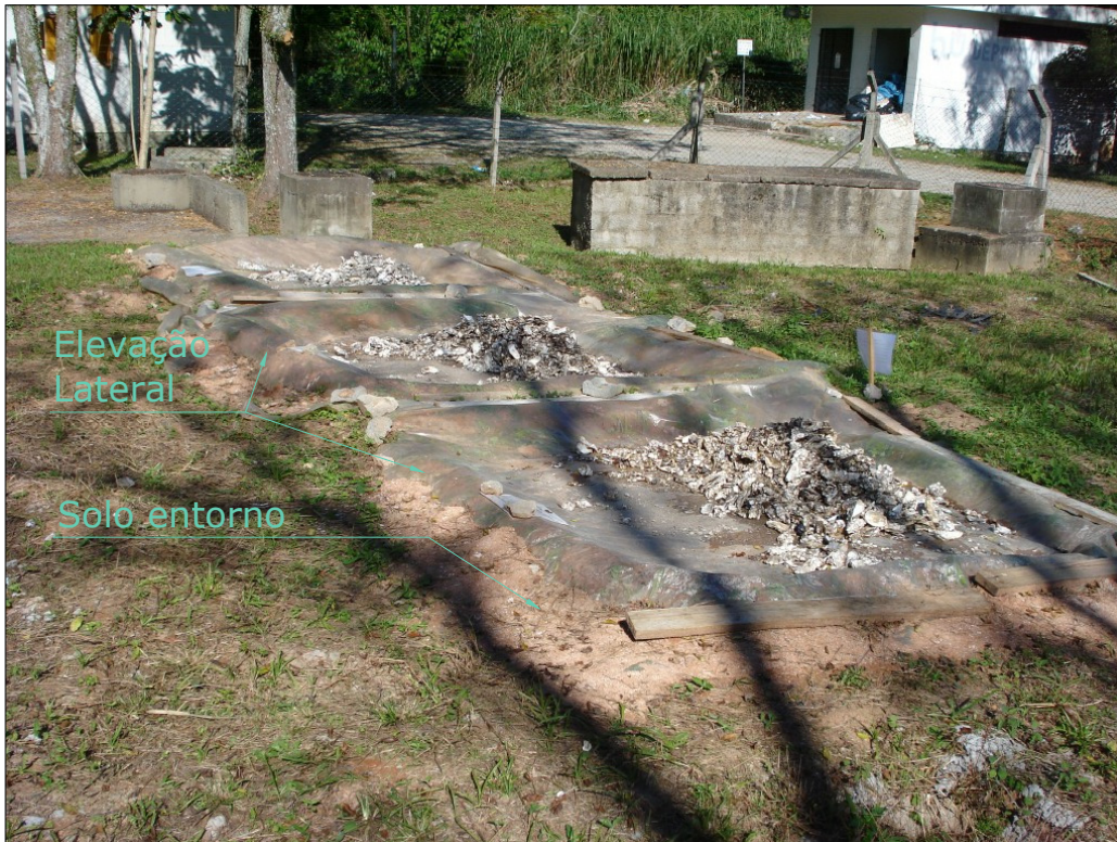
Figura 5-1: Proteção contra a entrada de solo
